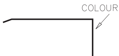
Barge Capping (GB3)
